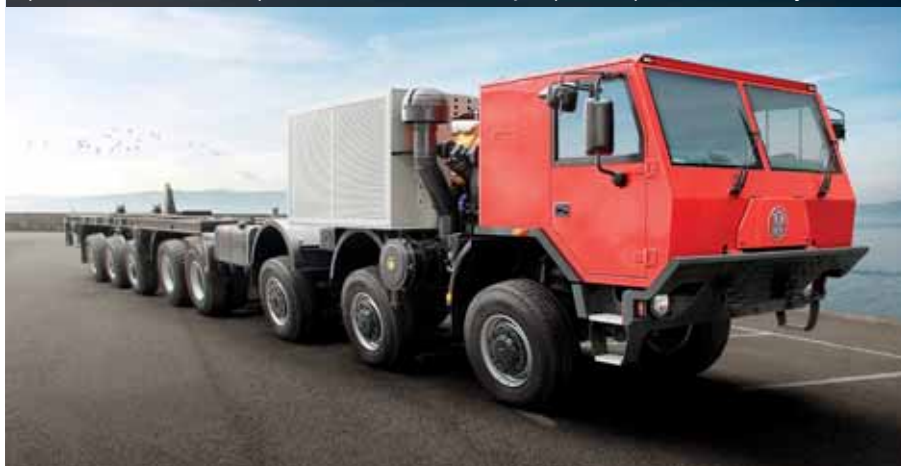
Špeciálna Tatra 16x8 na prevoz vrtného zariadenia je v ponuke pre ťažobné firmy.
